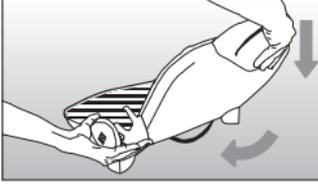
Bir elinizle sapı kavrarken, diğer elinizle resimdeki gibi mafsallı yukarıya kaldırarak, üst pişirme grubunu yatay hale getiriniz. Bu konumda alt ve üst pişirme grupları aynı seviyede olacaktır.
